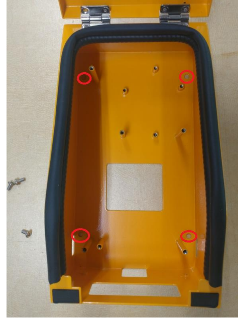
단말기 커버 4개의 나사를 제거해줍니다 (전동드라이버 사용시 고무패드에 닿지않 게 주의해주세요)
